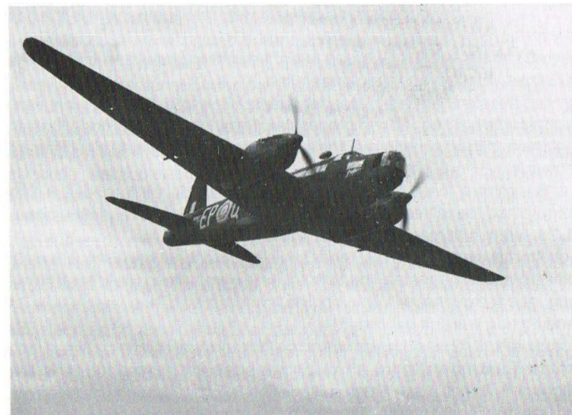
De Vickers Wellington was een tweemotorig vliegtuig met een spanwijdte van 26,5 meter en een lengte van 20 meter; het woog beladen 13.000 kilo en kon 12.000 mijl vliegen met een snelheid van maximaal 375 km/uur op een hoogte van 3500 meter. Voor zijn verdediging beschikte het over 6 machinegeweren. De bemanning bestond uit 6 personen.
