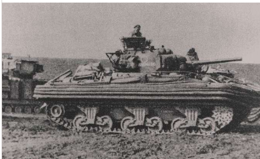
DD-tank met ingeklapte kap boven de rupswielen.
